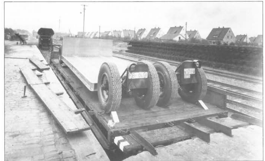
Noch einmal der auf die Bahn verladene Tiefladeanhänger. Im Hintergrund ein Schüttgutwagen, der wohl Nachschub für einen örtlichen Kohlenhändler bringt. Die abgebauten Gleise rechts im Bild könnten von den ehemaligen Abstellgleisen stammen, die im Zweiten Weltkrieg im Bereich Vorderflöß angelegt worden waren (vergleiche Heft Nr. 56)
