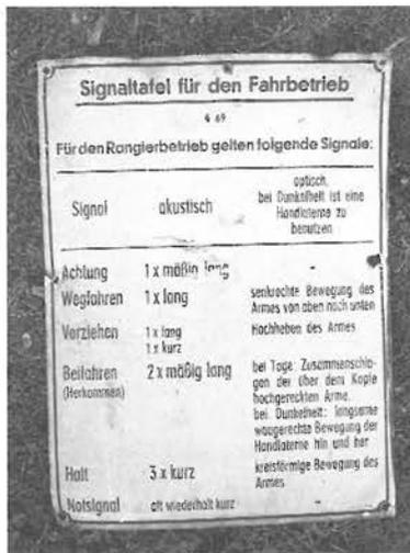
Ehemalige Signaltafel auf dem Gelände der Firma Lipp-springer Baustoffwerk, die auch eine eigene Rangierlokomotive betrieb. Festgelegt sind die zu verwendenden Rangiersignale in akustischer Form – wahrscheinlich Pfeifsignale mit der Handpfeife – sowie in Form von Handzeichen. (Aufnahme: Verfasser)
